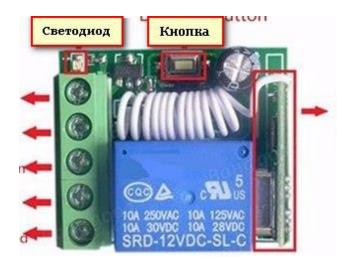
Сброс кода всех привязанных ранее ПДУ: Нажмите 8 раз кнопку на плате и светодиод замигает, указав на то, что память радиореле стёрта.
