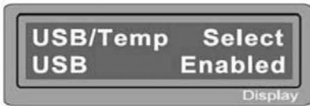
Если параметр установлен как USB порт, Вы можете подсоединить ЗУ к вашему ПК через дополнительный кабель USB, чтобы контролировать процесс заряда на экране монитора.
