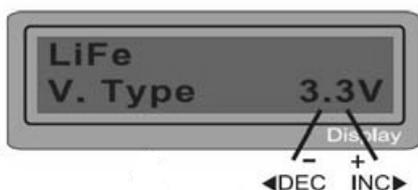
Данный экран отображает номинальное напряжение для литиевой батареи. ЗУ работает с тремя типами батарей и для каждого типа используется своё напряжение: -**Li-Fe** (3.3 В), -**Li-Ion** (3.6 В), -**Li-Po** (3.7 В) – параметр установлен по умолчанию
