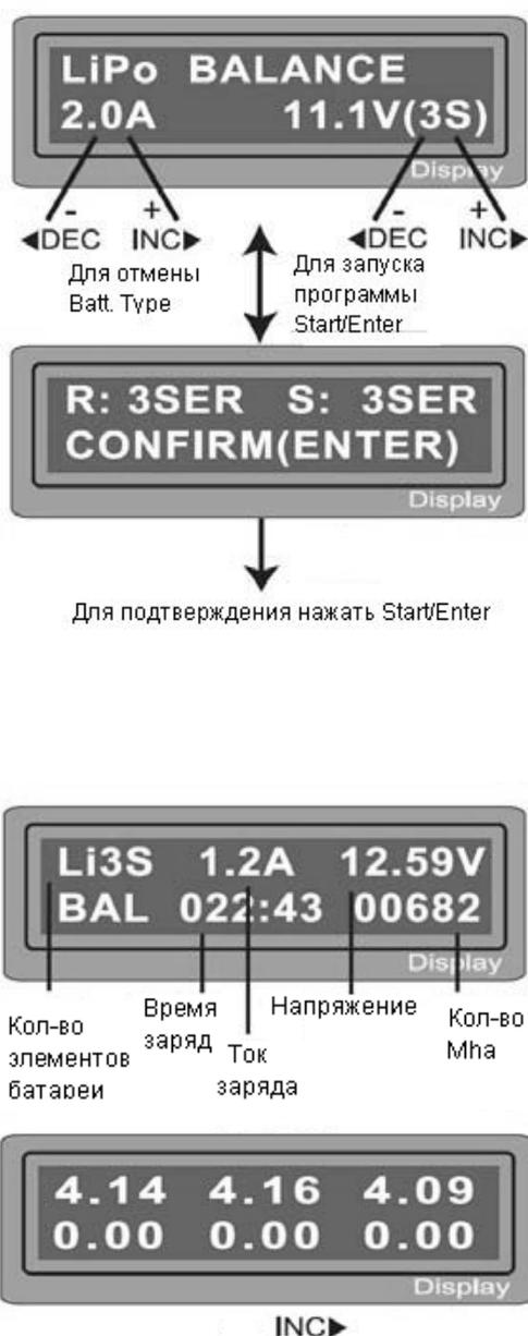
На этом экране слева сверху отображается тип заряжаемой батареи, ниже - текущий ток заряда. После установки параметров тока и напряжения, нажмите кнопку **“START/ENTER”** и удерживайте её нажатой в течение 3-х секунд, до тех пор, пока не прозвучит мелодия. (Для отмены и возврата в предыдущее меню нажмите **“Batt. Type/Stop”**)
