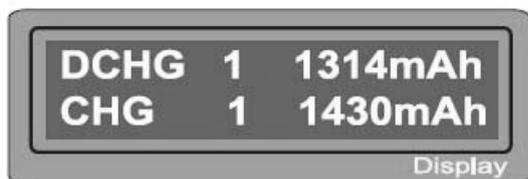
После окончания всех операций заряда/разряда, ЗУ оповещает о завершении звуковыми сигналами. На экране можно увидеть результаты работы зарядного устройства: какая емкость была выдана аккумулятору и какая забрана. Нажатием "INC" и "DEC", можно посмотреть результат по каждому циклу.
