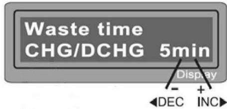
Данный экран отображает настройку времени охлаждения. Батарея нагревается в процессе разряда/заряда, поэтому необходимо давать ей время остыть. Программа ставит временную задержку после каждого цикла заряда/разряда, чтобы позволить остыть батарее, перед тем как начнется следующий цикл. Параметр может принимать значение от 1 до 60 мин.
