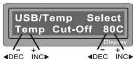
У зарядного устройства **Imax B6** слева находится 3-х пиновый порт для подключения термодатчика. Если экран показывает настройку температуры (как изображено на рисунке слева), Вы можете использовать дополнительный температурный контроль. Здесь можно выставить температуру отсечки. Процесс заряда будет закончен автоматически, как только температура батареи достигает заданного параметра. Температура также может быть установлена в течение процесса заряда.
