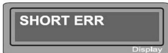
Короткое замыкание на выходных клеммах
