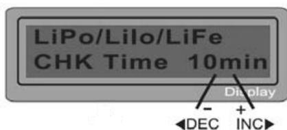
ЗУ автоматически распознает количество элементов в литиевой батарее перед началом процесса заряда/разряда. Это сделано для проверки конфигурации после настроек пользователем. В случае если батарея сильно разряжена, автоматическое определение работать будет некорректно.
