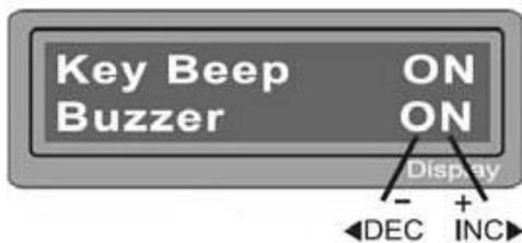
Здесь можно включить либо выключить сигналы событий, а также звук нажатия кнопок.
